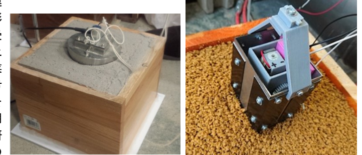
写真 5 落錘衝撃試験 写真 6 地盤に貫入した土砂サンプリング装置
