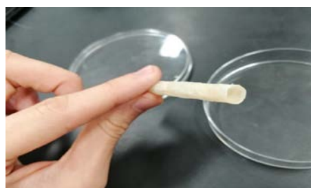
図5 完成した紅茶キノコの菌株由来のバクテリアセルロースストロー
