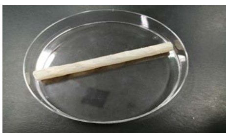
図5 完成した紅茶キノコの菌株由来のバクテリアセルロースストロー
