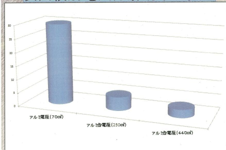
しかし、約 90 億 m<sup>3</sup> の田沢湖を中性にするには、気の遠くなる時間がかかるため、効率化を図る必要があります。しかし、高い電圧は危険であり、電圧を変えずに大きな電流を流すには、電極板の表面積を増加させればよいと考えました。
