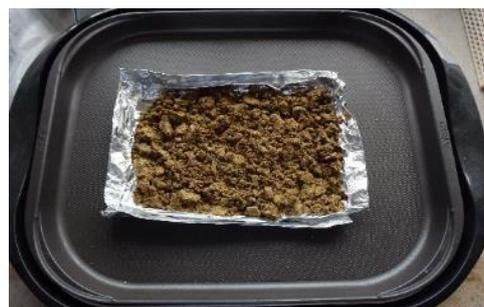
図-8 試料200gをホットプレートで2時間乾燥させ, 水分量を測定
